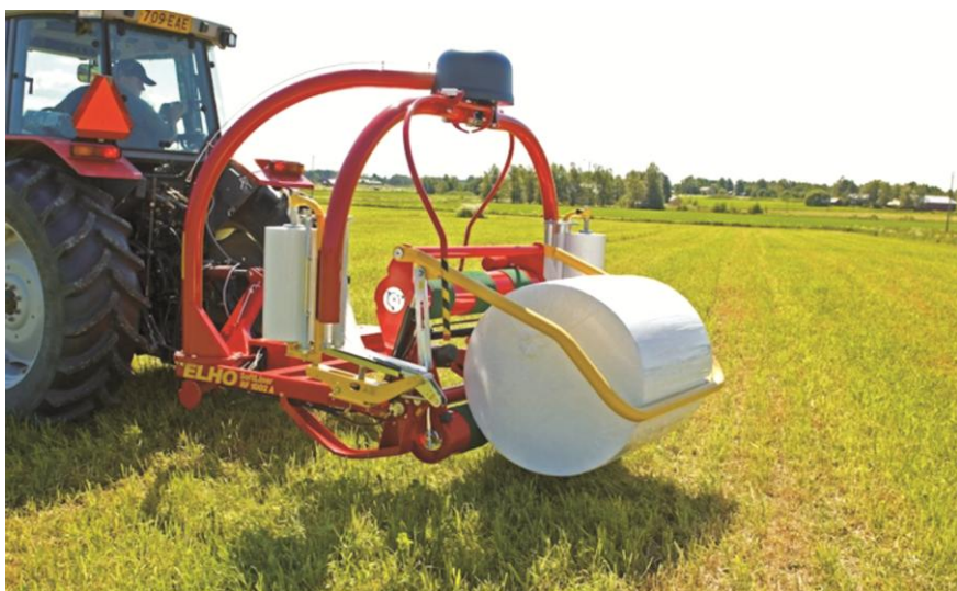
Транспортировщик рулонов с самопогрузкой и саморазгрузкой
